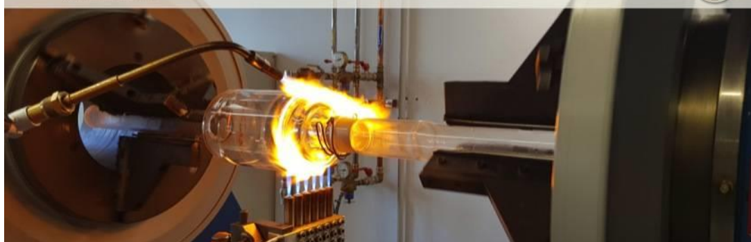
Herstellung des Hydrolathelms nach Claudia Neumaier – Foto: Gaßner Glastechnik GmbH
