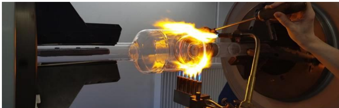
Herstellung des Hydrolathelms nach Claudia Neumaier – Foto: Gaßner Glastechnik GmbH
